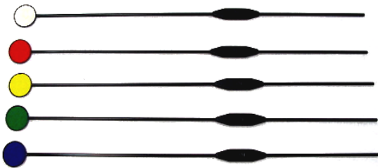
HE-150 視野検査用指標 Test Objects For Perimeter A1:Φ1.25 A2: 2.5 A3:5 A4:10 A5:20 (mm) 色→白・赤・緑・青・黄
