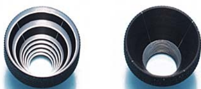
HS-2847A/B 手術用ケラトスコープ Surgical Placido Disc 手術後の直情上10mmにおき、手術用顕微鏡の照明 光をあてますと、角膜上に鮮明なプラチードリングが 投写され角膜縫合状態の適否を判断できます。
